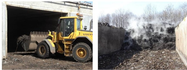
Figur 18: Tømning af boks for afgasset og forkomposteret materiale samt silo til efterkompostering
