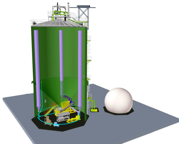
Figur 11: Opbygningen af en Dranco-Farm reaktor
